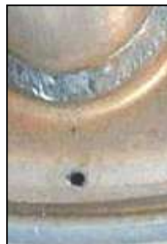
Drainhole y juntas no estancas
